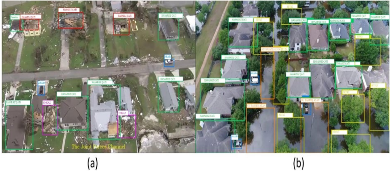
Şekil 11. Kırmızı çerçeve hasarlı çatı, yeşil çerçeve hasarsız çatı, mavi çerçeve araba, mor çerçeve enkaz alanı, turuncu çerçeve su basmış alan, sarı çerçeve bitki örtüsü alanını gösterir. Görüntünün (a) kısmında 2 araba, 6 hasarsız çatı, 3 hasarlı çatı ve 2 enkaz alanı ESA ile tespit edilmiştir. Görüntünün (b) kısmında ise 3 araba, hasar görmemiş 12 çatı, 8 bitki örtüsü ve 3 su basmış alan ESA ile tespit edilmiştir.
