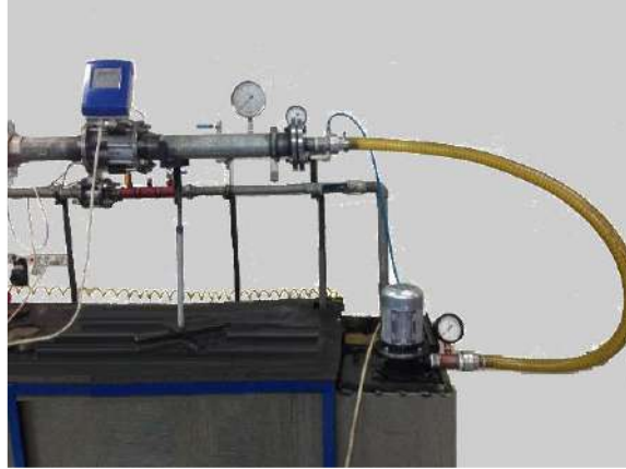
Şekil 3. Pompa performansı deney düzeneği
